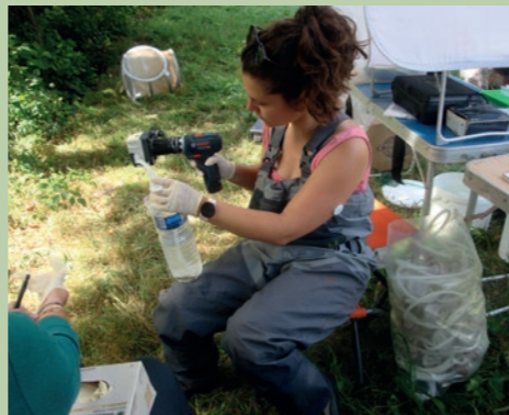
4 Piégeage à Cier de Luchon On retire le poisson de la bouteille et on filtre l'eau à l'aide d'une perceuse « revisitée » : la perceuse active une pompe péristaltique* pour piéger les particules d'ADNu (u pour urine) ou les spores de PKD
