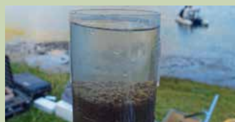
La mémoire du lac. L'interface eau/sédiment de la carotte prélevée dans le lac d'Espingo lors de la campagne d'instrumentation réalisée par le laboratoire GEODE (CNRS/université de Toulouse)
